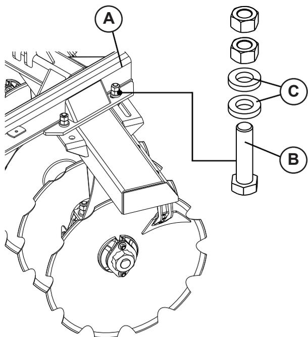
1. Fixe os chassis (dianteiro e traseiro), no quadro (A), através dos parafusos (B), arruelas lisas (C) e porcas.
