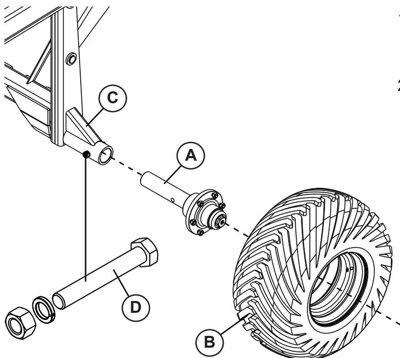
1. Prenda o cubo (A), na roda (B), através dos parafusos e porca do cubo (A).
