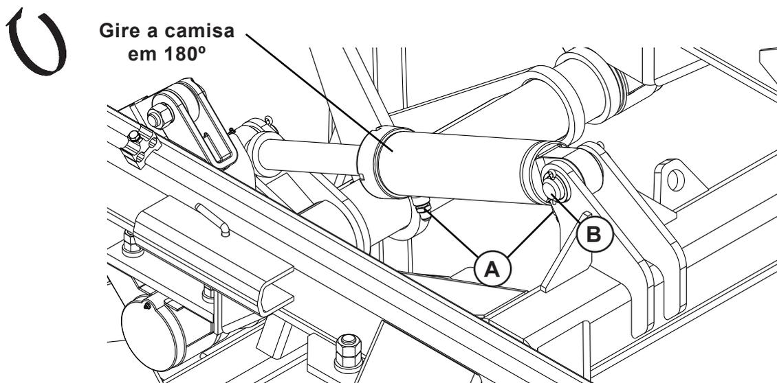
Em seguida faça a movimentação de 180°, deixando os terminais (A) virados para cima.
